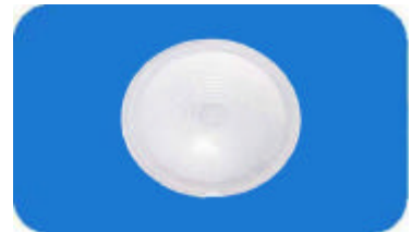
Type : 8222-1(Plane) focus : 20 angle : 60 ° distance 比 : 6:1 dimension : 22 thickness:0.6
