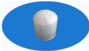
Type : 8308-2(circular cylinder ) focus : 9.5 angle : 140 ° distance : 8m dimension : 12.5 high:14.30
